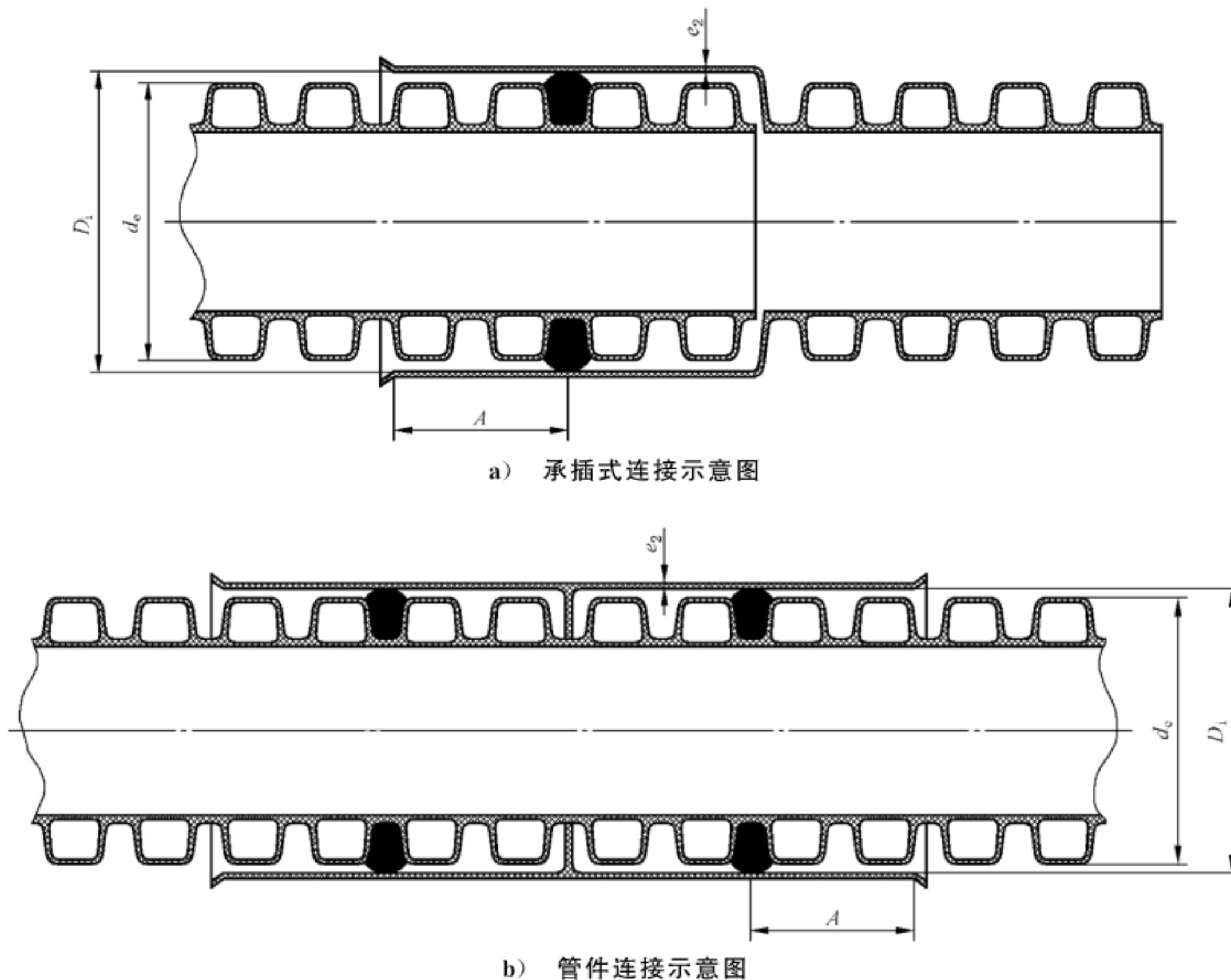
图 2 管材连接示意图
