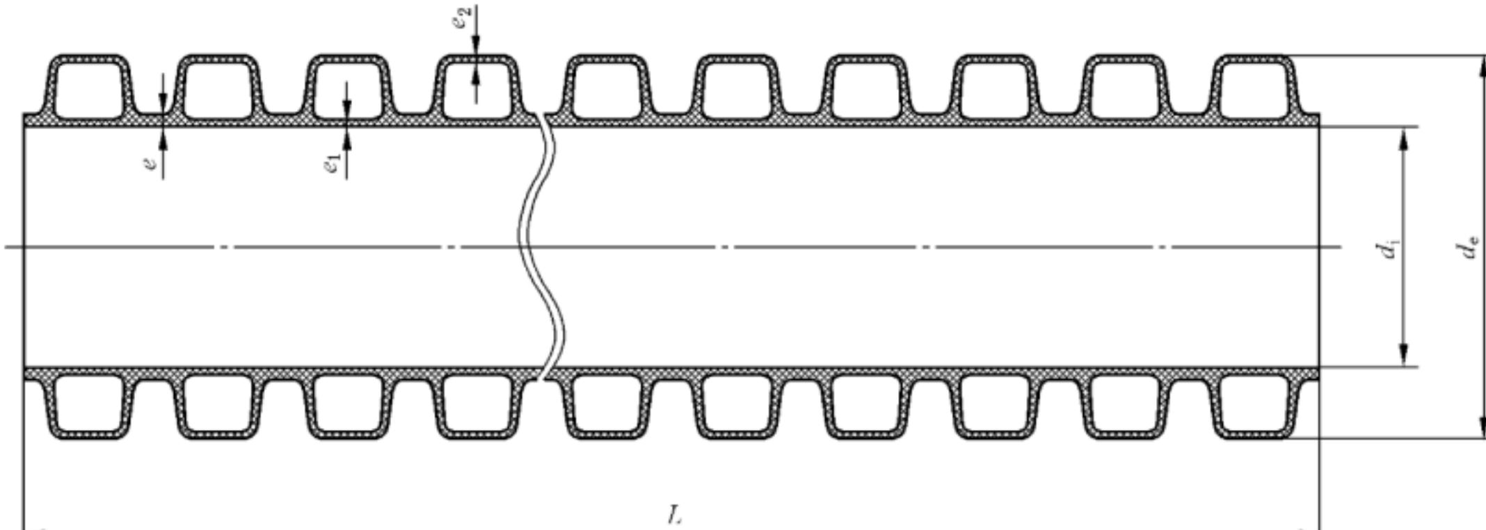
b) 不带扩口管材结构示意图
