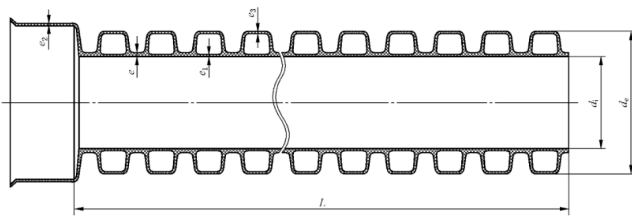
a) 带扩口管材结构示意图
